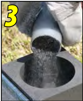
Pour powder into crucible
